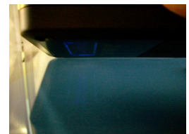
Abbildung 4: Luftseite (NICHT Zinnseite) Stumpfe Reflexion der UV-Lampe
