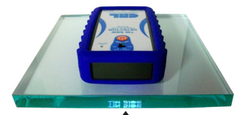
Abbildung 5: Schablonierte Wort auf der Zinnseite des Glases
