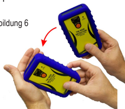
Abbildung 8: Entfernen Sie die Batterien und die 4 Schrauben des Gehäuses
