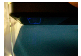
Figure 4: Face air (PAS la Face étain) Réflexion terne de la lampe violette
