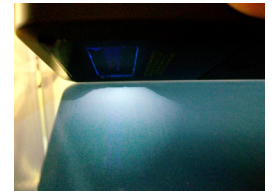
Figura 3: Lado con Estaño Reflexión blanca y lechosa.
