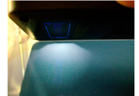
Figure 3: Face étain Réflexion de couleur blanc laiteux
