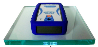
Figura 5: Imagen estarcida en el lado con estaño.
